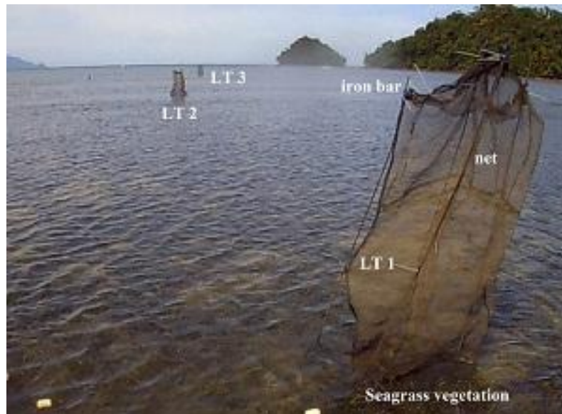
Gambar 5. Perangkap serasah (LT) lamun dengan luas alas 0,5 x 0,5 m Figure 5. Seagrass litter trap (LT) with base dimension of 0.5 x 0.5 m
